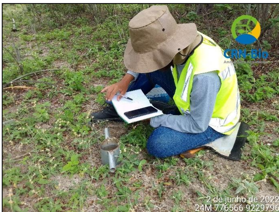
Figura 4.27: Realização do teste de infiltração do solo.
